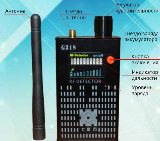
Имеет SMA разъем на верхней части для антенн. На лицевой стороне расположена 9 ступенчатая система светодиодных индикаторов, первый из которых указывает на работу, а остальные на силу обнаруженных сигналов. Так же, на передней лицевой поверхности имеется индикатор заряда и кнопка включения прибора.
